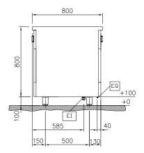
Electrical inlet (power) Equipotential screw
